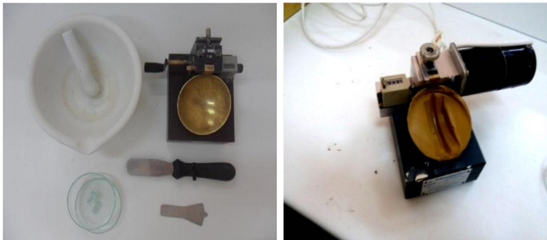
Figure II.4 : Appareillage de limites d'Atterberg
