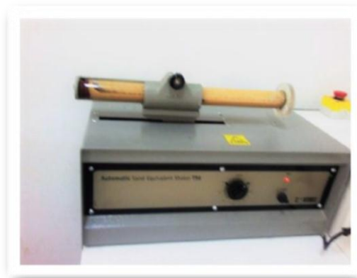
Figure II.14: Premier étape de l'essai équivalent de sable.
