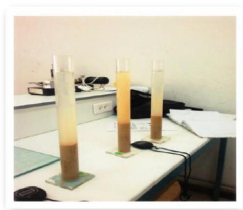
Figure II.15: Deuxième étape de l'essai équivalent de sable.
