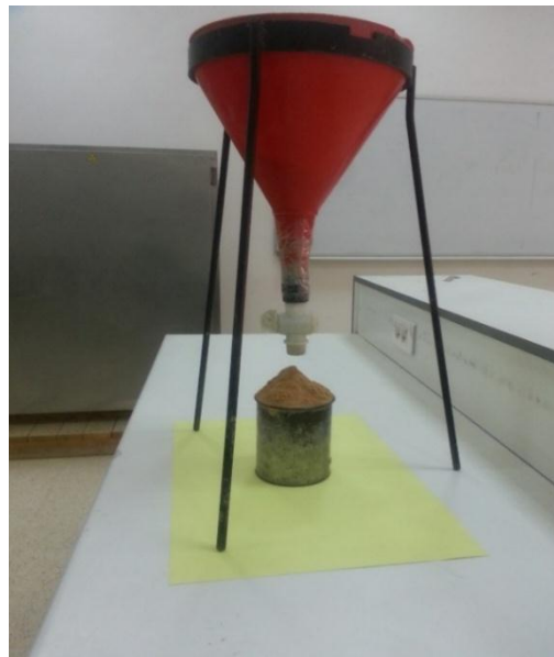
Figure II.16 : L'essai de la masse volumique apparente
