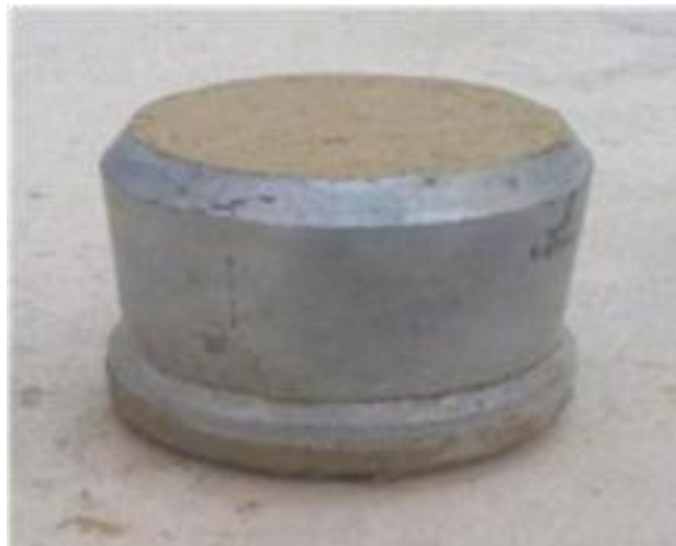
Figure II.1 : Détermination du poids volumique humide.
