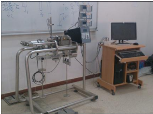
Figure II.12 : Appareille de cisaillement direct.
