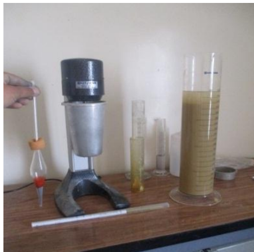
Figure II.3 : Appareillage de l'analyse granulométrique par sédimentométrie.
