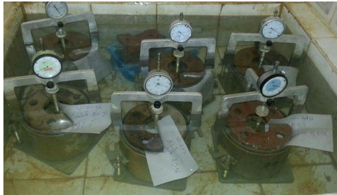
Figure II.10 : Imbibition des échantillons (essai C.B.R)
