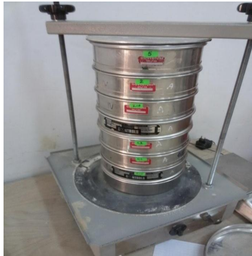
Figure II.2 : Appareillage de l'analyse granulométrique par tamisage.
