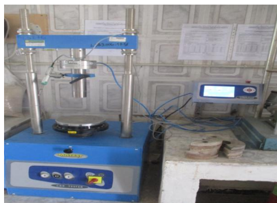
Figure II.9 : Appareil de poinçonnement (essai C.B.R).
