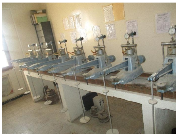
Figure II.11 : Appareil œdométrique
